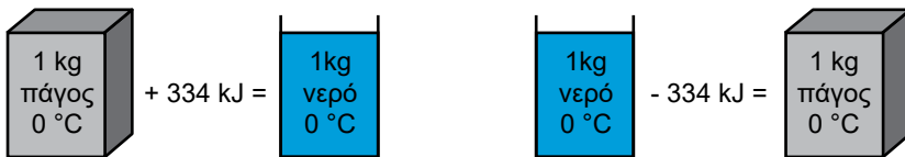
Εικόνα 1.27: Σε κανονική ατμ. πίεση η λανθάνουσα θερμότητα τήξης και πήξης για το νερό είναι ίσες ( 334 \text{ kJ/kg} \approx 80 \text{ kcal/kg} ). Η αντίστοιχη θερμοκρασία (τήξης ή πήξης) είναι 0 \text{ }^\circ\text{C}
