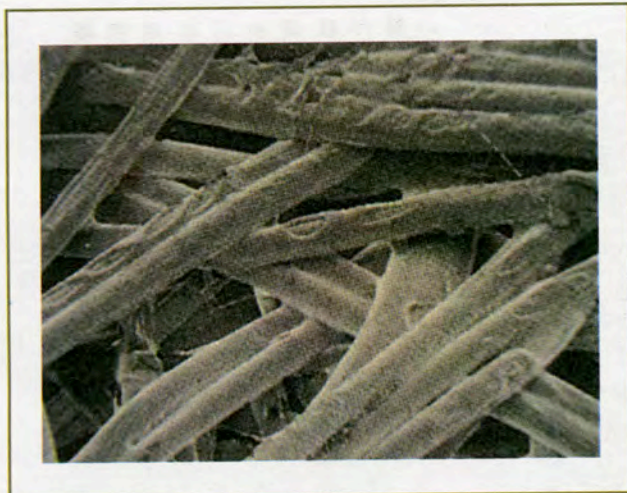
Εικόνα 1.4: Δομή μη υφάνσιμου προϊόντος σε μεγέθυνση
