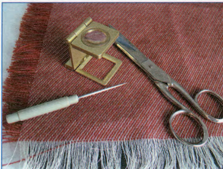
Εικόνα 3.23 Εργαλεία που χρησιμοποιήθηκαν στην ανάλυση του υφάσματος
