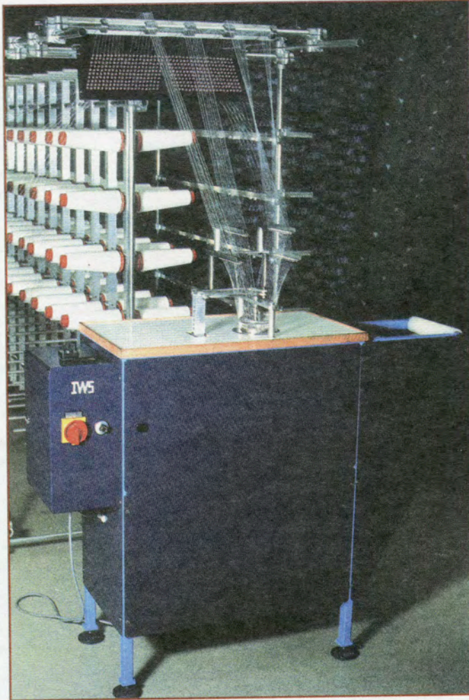
Εικόνα 2.17: Κυκλική στημονομηχανή για δίχτυα
