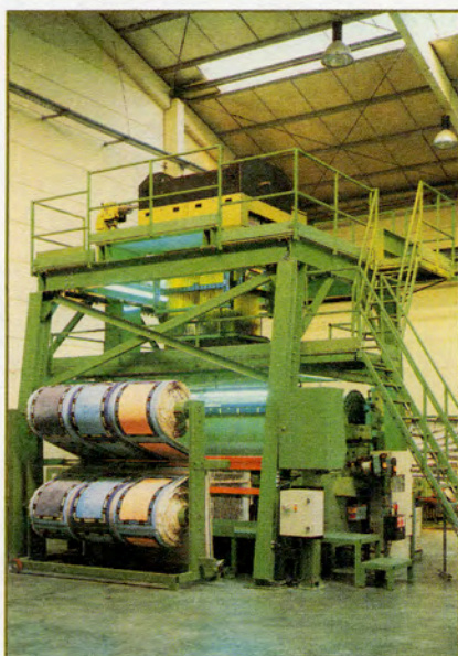
Εικόνα 6.10: Υφαντική μηχανή κατασκευής διπλού βελούδου
