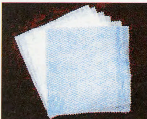
Εικόνα 5.4: Μη υφάνσιμα κατασκευασμένα με υγρή μέθοδος
