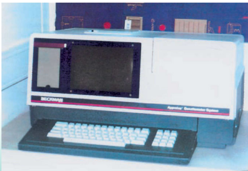
Εικόνα 1.4: Συσσκευή ποσοτικού προσδιορισμού των διαφόρων κατηγοριών των πρωτεϊνών του ορού (Densitometer).
