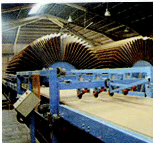
Εικ. 11.8 Μηχανή κλιματισμού μοριοσανίδας
