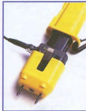
Εικ. 2.12 Ηλεκτρικό υγρόμετρο για μέτρηση υγρασίας
