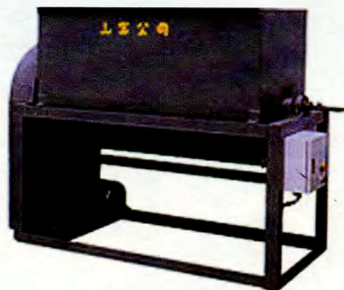
Εικ. 11.5 Μηχανή ανάμειξης ξυλοτεμαχιδίων με συγκολλητική ουσία
