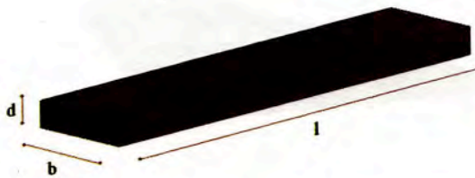
Σχ. 14.1 Ογκομέτρηση μασίφ πριστής ξυλείας Σχ. 14.2 Ογκομέτρηση μασίφ στρογγύλης ξυλείας
