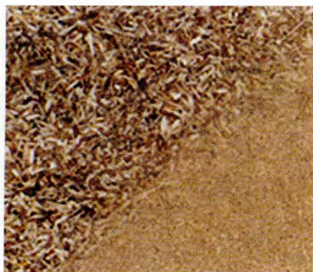
Εικ. 11.4 Ψεκάσμος συγκολλητικής ουσίας στα ξυλοτεμαχίδια
