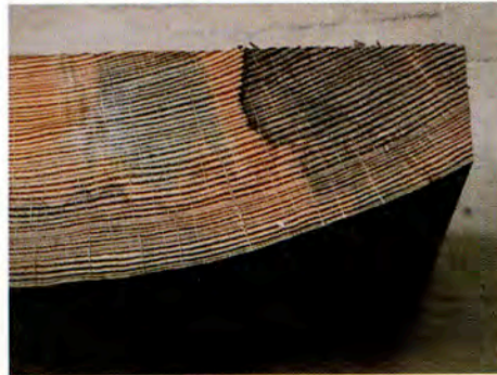
Εικ. 4.1 Εμφάνιση κυάνωσης σε εγκάρσια τομή πεύκου
