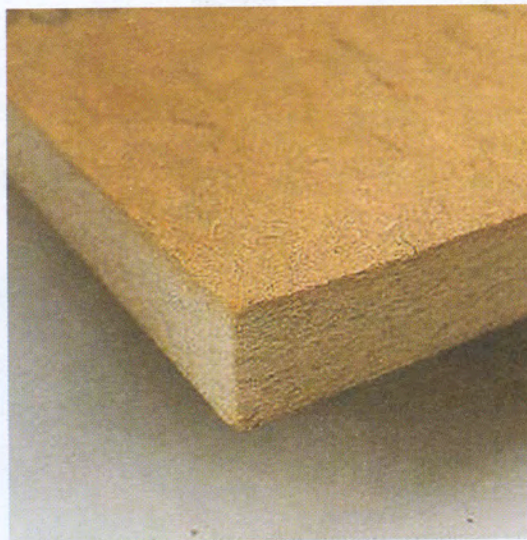
Εικ. 2.6 Θερμομονωτική ινοπλάκα από ίνες ξύλου
