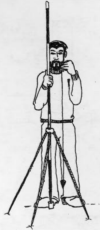
Κατακόρυφωση ακοντίου με τη βοήθεια νήματος της στάθμης
