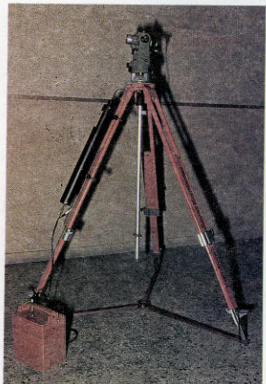
Θεοδόλιχο εφοδιασμένο με συσκευή laser
