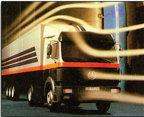
Εικόνα 8.2.2 Έλεγχος αεροδυναμικής συμπεριφοράς φορτηγού αυτοκινήτου σε αεροσήραγγα
